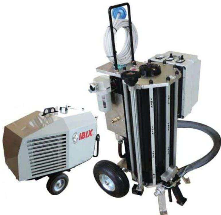
Noleggio **Sabbiatrice IbiX 9** dotata di **Compressore IB 2000**, con il supporto di un operatore qualificato, anche tecnico di restauro in elenco Mic, per operazioni di pulitura Aeroabrasiva su edifici antichi. La **Sabbiatrice IbiX 9** veloce e sicura, impiega solo materiali atossici e non inquinanti e garantisce il massimo rispetto dell'ambiente e degli operatori
